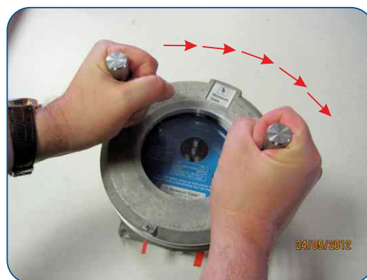
Po prawidłowym włożeniu klinów mocujących pokrywę do otworów przekręcić w kierunku wskazówek zegara w celu dokręcenia pokryw.
