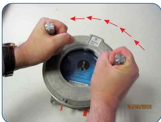
Po prawidłowym włożeniu klinów mocujących pokrywę do otworów przekręcić w kierunku przeciwnym do wskazówek zegara w celu poluzowania pokryw.
