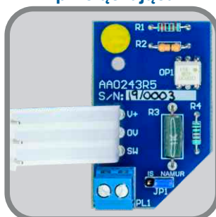
Opcjonalna iskrobezpieczna płytki drukowana przełączająca
