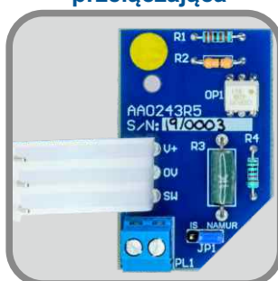
Opcjonalna iskrobezpieczna płytki drukowana przełączająca
